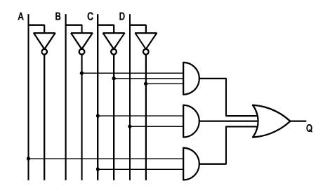
$$Q = \overline{A}.\overline{B}.\overline{C}.\overline{D} + \overline{A}.\overline{B}.C.D + \overline{A}.B.C.D + A.\overline{B}.\overline{C}.\overline{D} + A.\overline{B}.C.\overline{D} + A.\overline{B}.C.D + A.B.C.\overline{D} + A.B.C.D = \overline{B}.\overline{C}.\overline{D} + C.D + A.C$$
