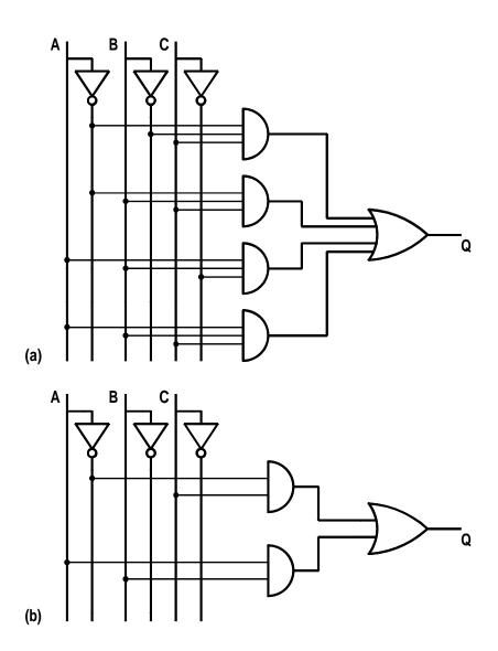
$$Q = \overline{A}.\overline{B}.C + \overline{A}.B.C + A.B.\overline{C} + A.B.C$$
